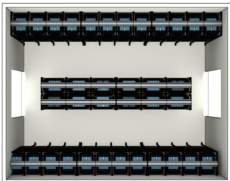
На следующем рисунке CAD показана типичная установка стеллажей Hugiëia в среде хранения ЦСО. Длинные стены оснащены стеллажами U-типа на колесах, в группах по 3 единицы, что позволяет легко маневрировать ими в целях очистки. Центральная часть комнаты оборудована стеллажами E-типа, тыльными сторонами друг к другу, что позволяет сохранить полезное пространство коридора для перемещения тележки между ними.
